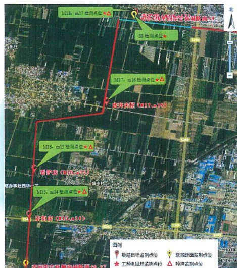
附图5 改接点~莘亭段 220kV 线路工程衰减断面及敏感目标检测布点图
