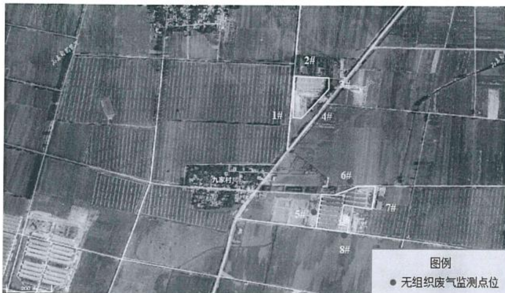
图 1 无组织废气监测布点图
